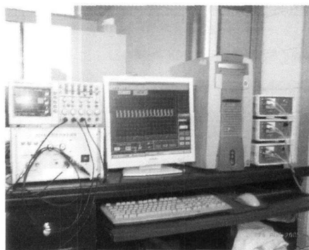
图2 数字光纤叶片振动测量系统
